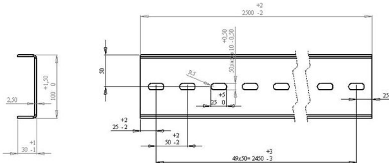
Идеально подходит для сборки конвейеров самостоятельно. Перфорация позволяет закрепить на раме опоры конвейера, датчики, приводную и натяжную станцию. Выбор цвета порошкового покрытия. Стоимость по запросу.
