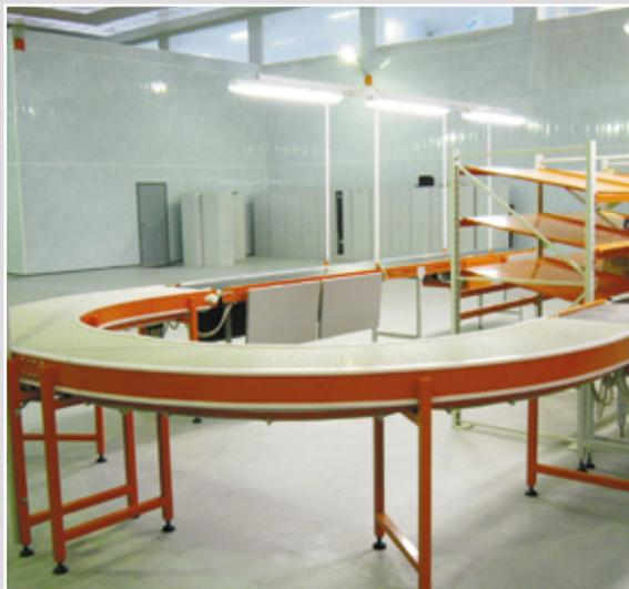
Высокая температурная область использования от  $-70$  до  $+130^{\circ}\text{C}$ . Ленты типа Flush Grid дают возможность для оптимального проникновения воздуха и жидкости сквозь ленту для лучшего охлаждения и мытья продукта при транспортировке.
